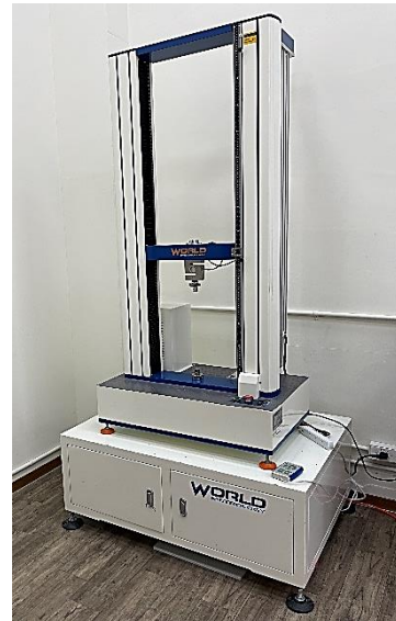
圖、SEM 桌上型掃描式電子顯微鏡及萬能拉力試驗機
