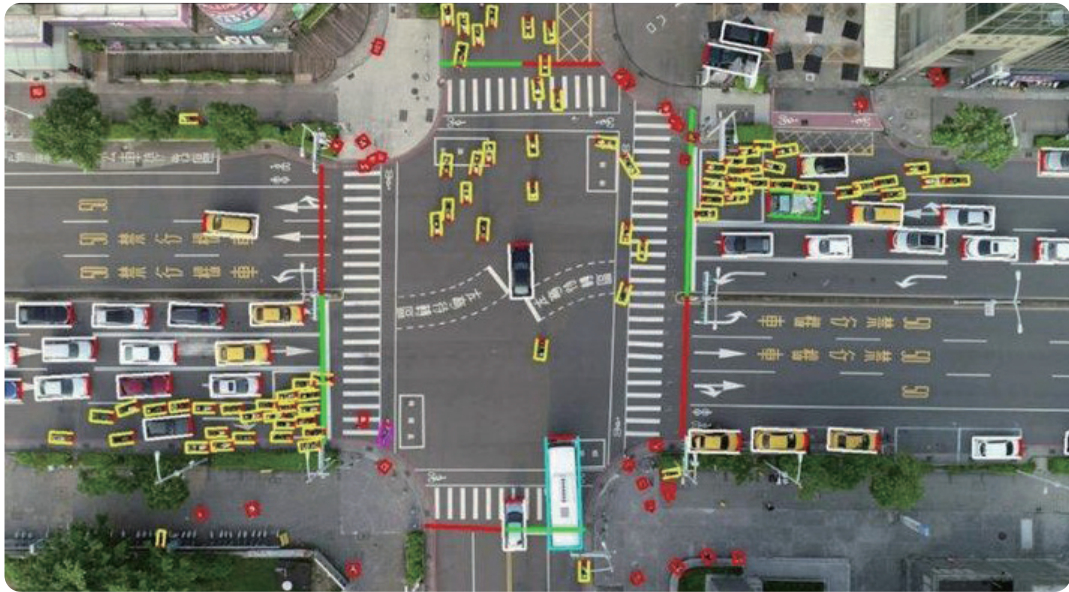
▲ 無人機「上帝視角」清楚辨識並追蹤路口人、車流動軌跡。圖／運研所提供
