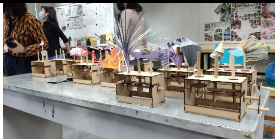
利用凸輪機構組裝原理，學員完成《動力藝術自造實作》作品
